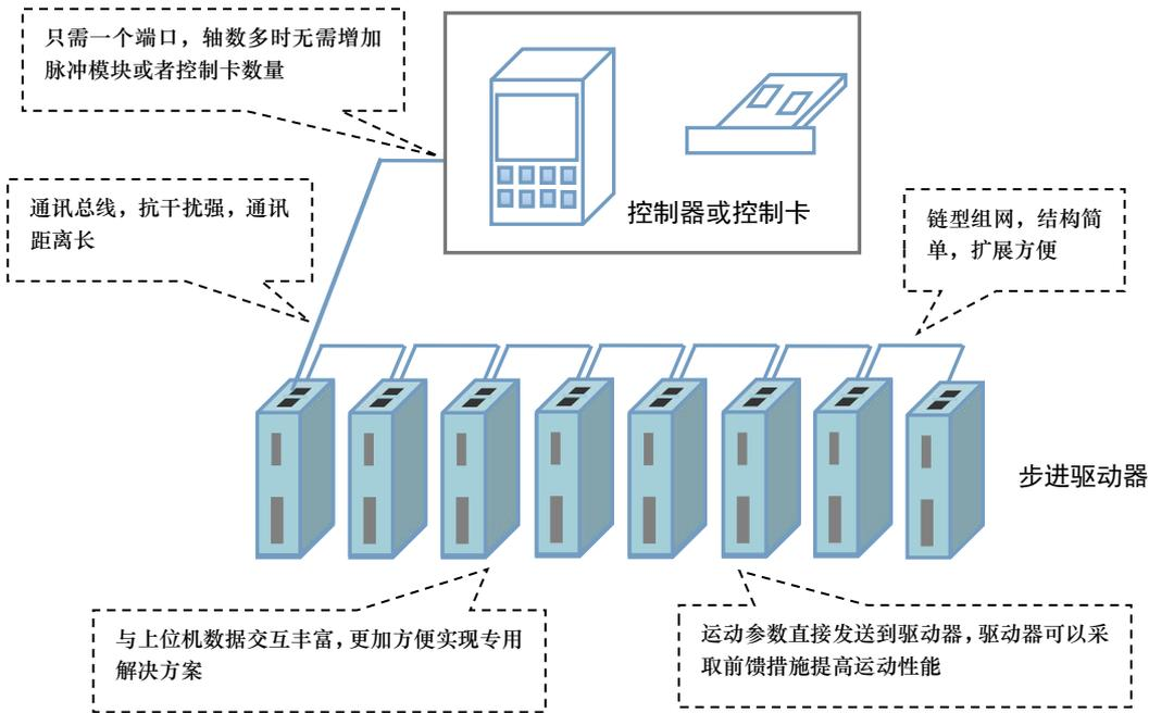
图 1-2 总线型步进组网方案
