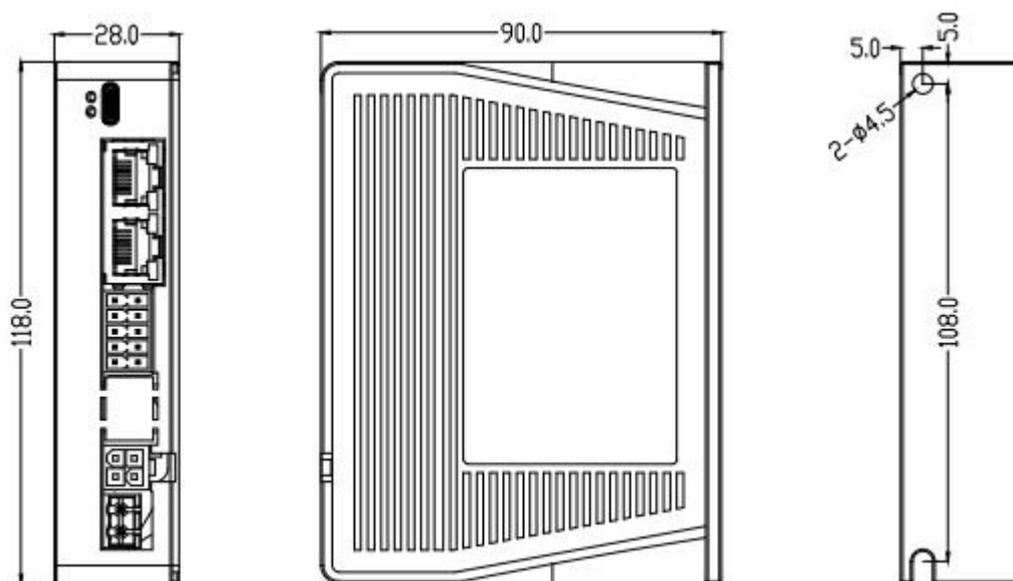
图 2-1 DM3B-EC522/542/556/570 安装尺寸图(单位: mm)
