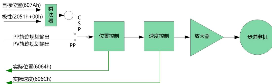
图 7.5 循环同步模式整体结构
