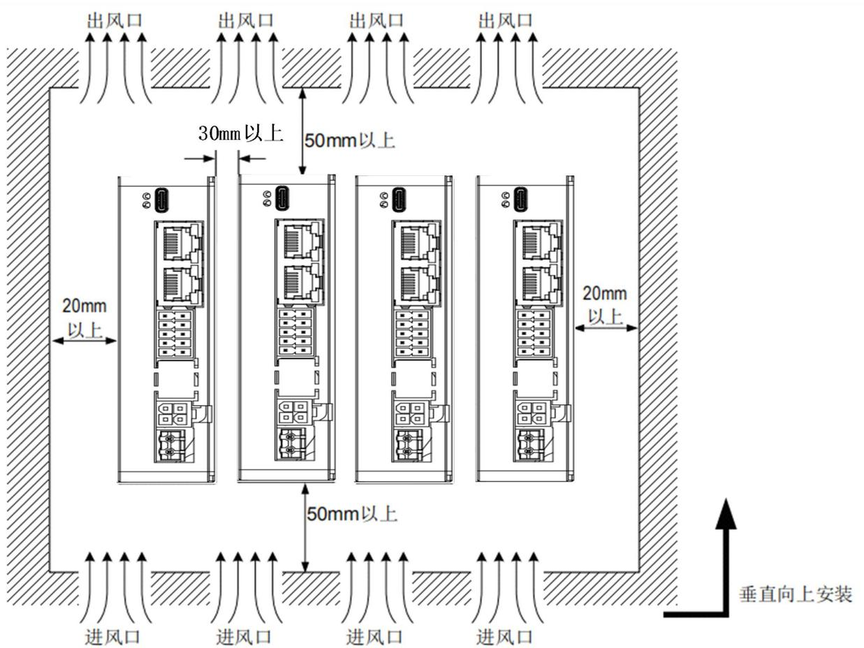
图 2-2 驱动器安装方式示意图
