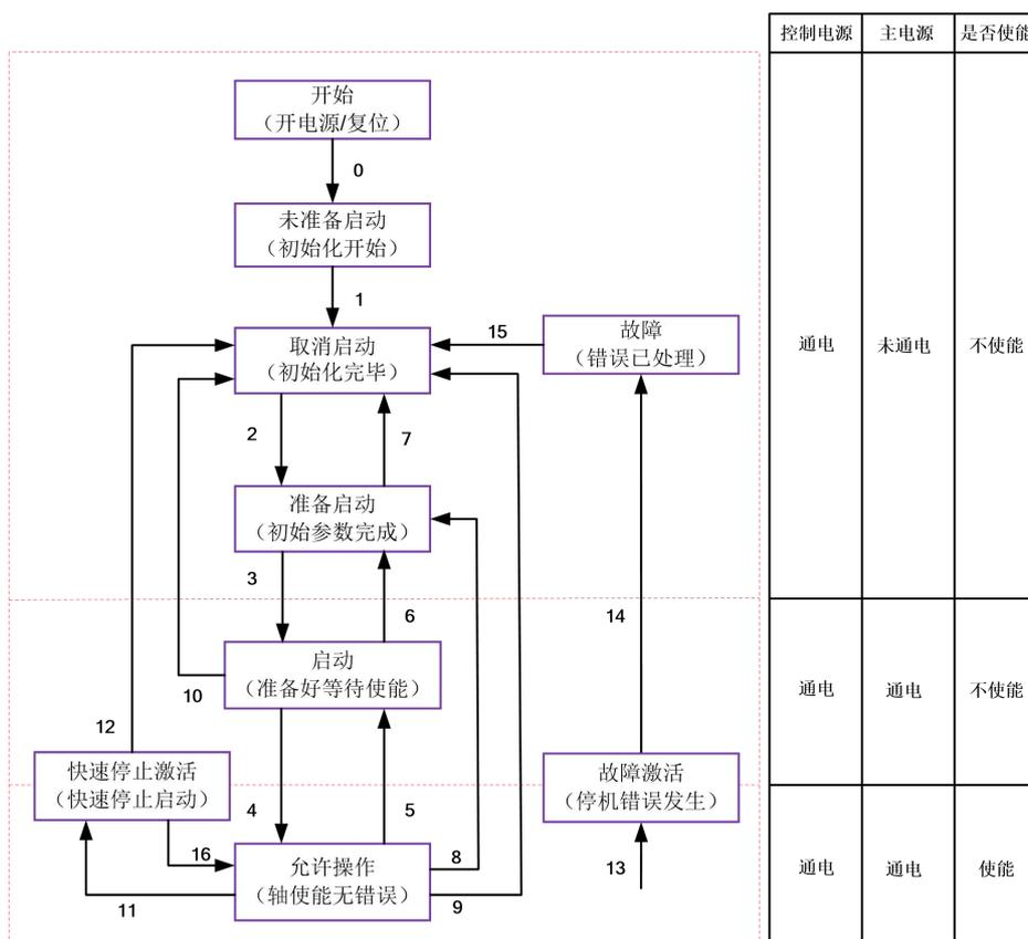
图 7.1 DM3B 的 402 状态机
