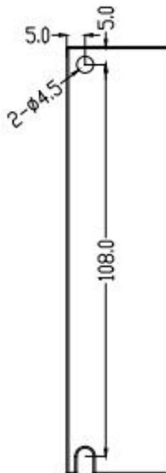
图 2-1 DM3B-EC522/542/556/570 安装尺寸图(单位: mm)
